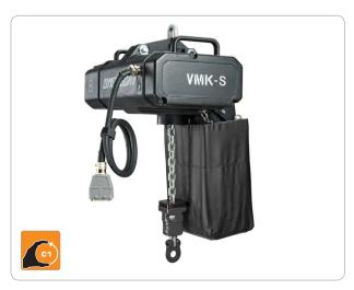
Die VMK-S Züge nach BGV C1, DIN 56950:2012-05 und EN 61508 SIL 3 und zeichnen sich durch eine innovative Ausstattung und eine besonders flexible Handhabung bei höchstem Sicherheitsanspruch aus. Im Besonderen sind das zwei unabhängige, geräuscharme sowie wartungsfreie Bremsen mit Luftspaltüberwachung, ein in die Einlochöse integriertes Echtzeit-Lastmessmodul,
